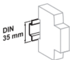
Mocowane zatrzaskowo na szynie DIN 35 mm
